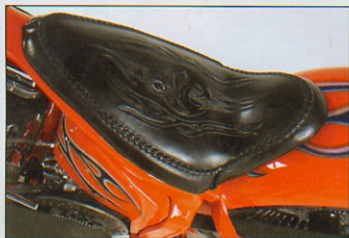
Desmodromik: Das Hinterteil des Lederbrötchens muß die Bewegungen der Schwinge und des Heckfenders mitmachen
